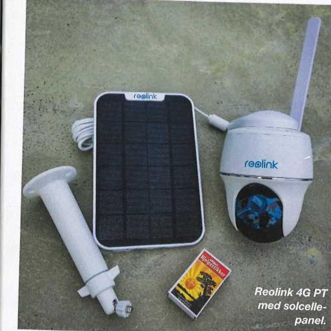
KAMERAET ER VÆRBESKYTTET til IP64, det vil si at det skal være støvtett og tåle vannsprut og kraftig regn fra alle kanter. Det er uansett formuftig å gi ekstra værbeskyttelse ute med et lite «overbygg», for eksempel med ei oppskåret spylevæskekasse. Selv henger jeg kameraet inn i en kasse og kamuflerte det litt ekstra med kamotape. Hvordan det klarer seg i lave temperaturer og kulde har jeg
