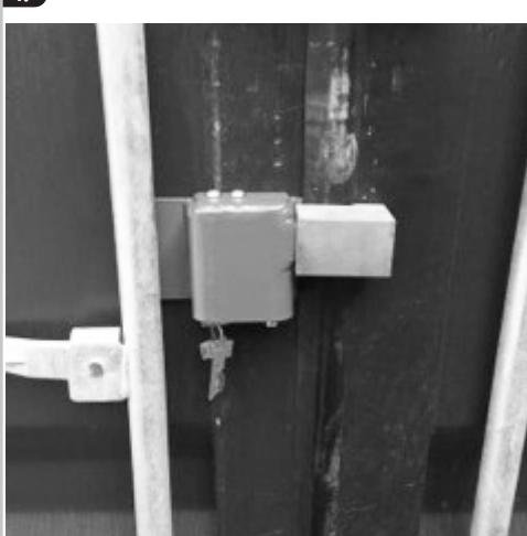
Schieben Sie den Bügel zurück in den Schlosskörper. Der Bügel verriegelt automatisch. Ziehen Sie den Schlüssel ab
